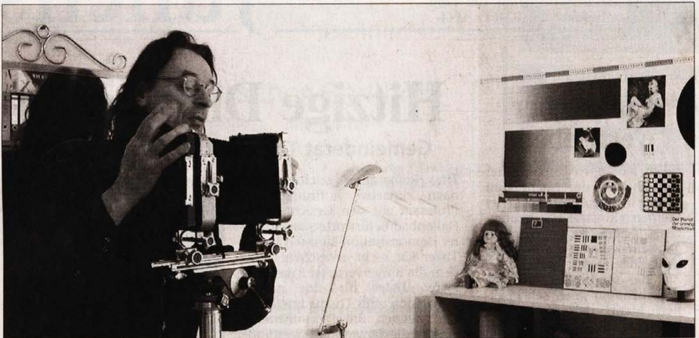
Um das Ergebnis von Film/Entwickler-Kombinationen zu analysieren, hat Heribert Schain eine Testwand (rechts) zusammengestellt, die er für jede Aufnahmeserie mit einer Fotolampe ausleuchtet. Foto: Wolters
